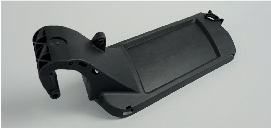
**Bild 1.** Scharnierarm für den Tankdeckel von Audi-Fahrzeugen: Durch die Umstellung auf ein PP mit recycelten Carbonfasern konnten das Gewicht um 32 % und die CO<sub>2</sub>-Emissionen um fast 75 % reduziert werden © Albis
